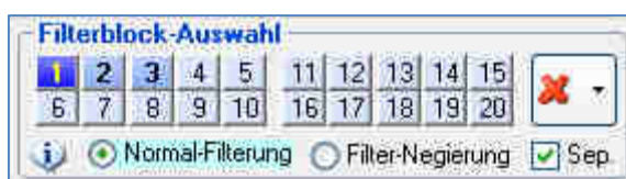
Abb.: Anzeige der Filterblock-Belegung, aktuell ist der Filterblock 1 (weil dunkelblau), für die Filterblöcke 2 und 3 sind Eingaben vorhanden, alle anderen Filterblöcke sind nicht belegt
