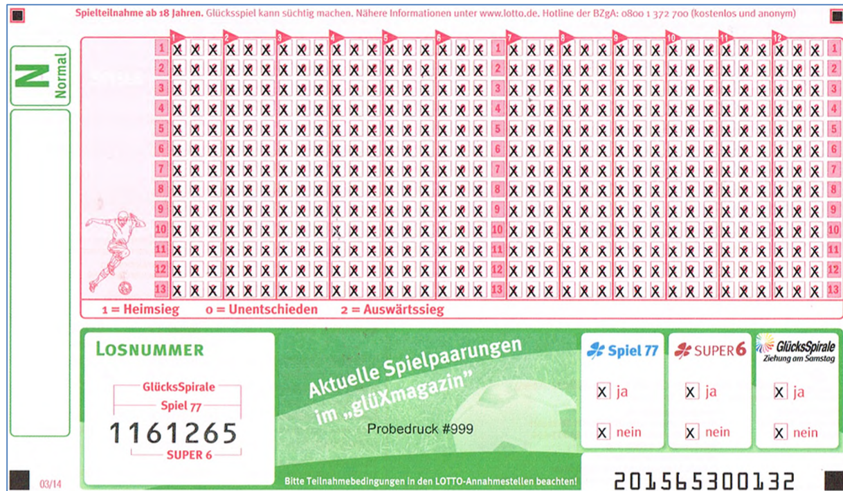
Abb.: Erster Probdruck - Der Druck in diesem Probdruck-Beispiel beginnt minimal zu weit links und zu weit unten. Für einen perfekten Druck sollten alle Kreuzchen weiter oben und weiter rechts platziert werden
