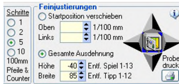
Abb.: Veränderung der gesamten Ausdehnung um 0,40 mm enger von oben nach unten und 0,85 mm breiter von links nach rechts
