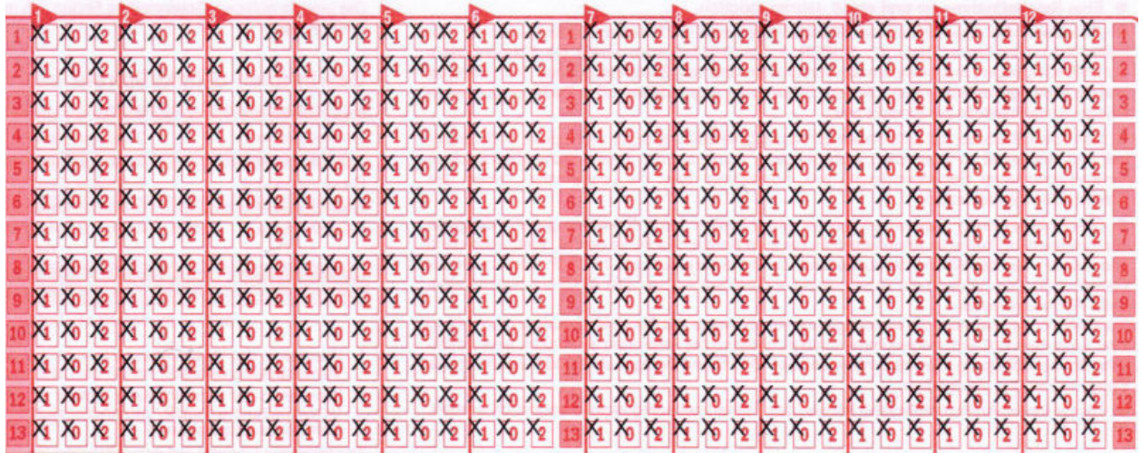
Abb.: Probedruck - Der Druck passt nicht und muss korrigiert werden
